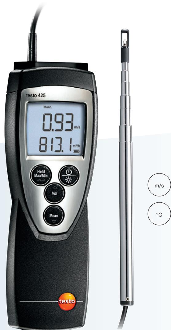
testo 425 ist ein kompaktes Anemometer mit fest angeschlossener thermischer Strömungssonde. Der Sondenkopf hat einen Durchmesser von 7.5 mm. Mit dem ausziehbaren Teleskop (Länge max. 820 mm) eignet sich das Messgerät zur Strömungsmessung im Kanal. Auch im schwierigen, unteren Strömungsbereich misst das testo 425 äußerst präzise.
